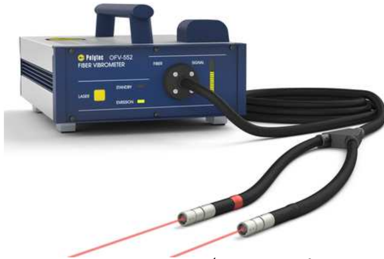
Figura AIX.1 – Sensor de Fibra Óptica POLYTEC® OFV-552.
