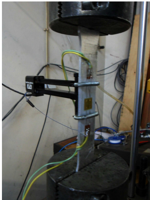
Figura AV.2 – Ensaio de tração para determinação das propriedades mecânicas do material.
