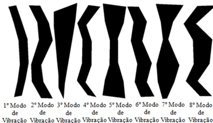
Figura 5.8 – Representação das 8 primeiras formas naturais de vibração do modelo experimental com junta rebitada composta por 5 rebites de 3,2 mm de diâmetro.
