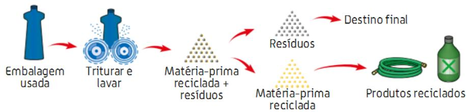
Figura 36 – Esquema representativo da reciclagem mecânica (reproduzido de [4])
