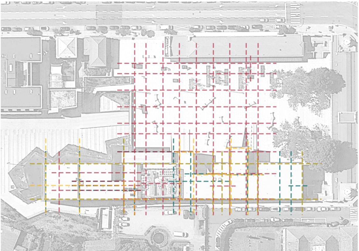
**DESENHO 18** PLANTA ESQUEMÁTICA DA SOBREPOSIÇÃO DOS EIXOS ESTRUTURAIS DO CENTRO DE ARTE.
