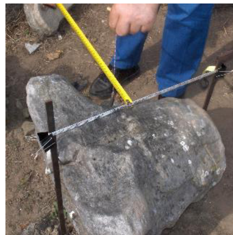
Figura 12 - Medidas obtidas com fio-de-prumo e fita métrica
