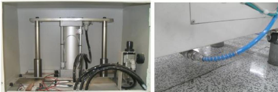
Figura 24: Cilindro pneumático e entrada do ar comprimido do ICT.
