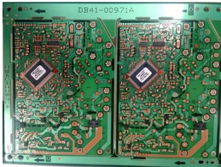
Figura 10: Placa após o processo de soldagem dos componentes SMD.
