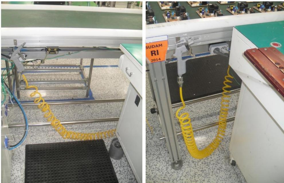
Figura 43: Pistolas a ar comprimido para auxílio na limpeza dos equipamentos da PBA 04.
