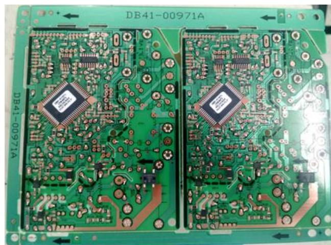
Figura 9: Placa após o processo de inserção dos componentes SMD.
