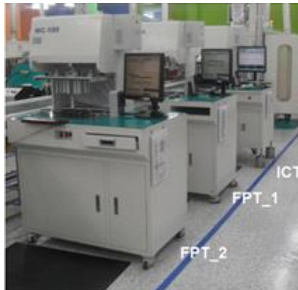
Figura 29: Posicionamento do ICT e dos dois FPT na linha PBA-04.
