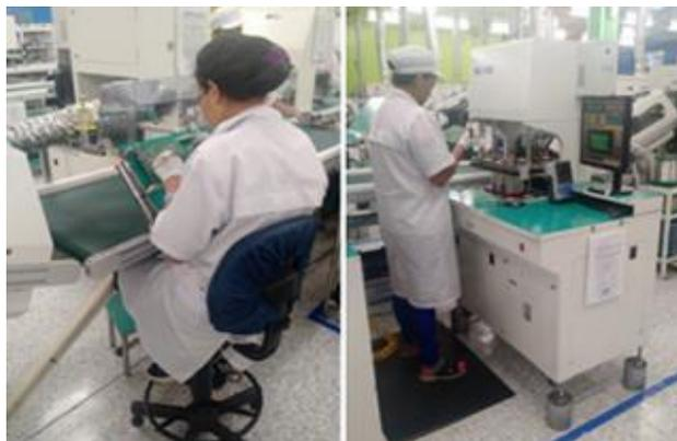
Figura 15: Revisão de solda e teste na máquina ICT.
