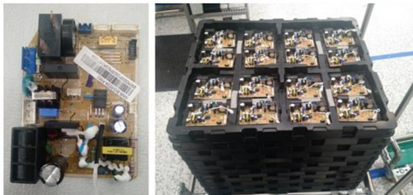
Figura 17: Placa após aplicação de silicone e etiqueta de identificação armazenadas na *box*.
