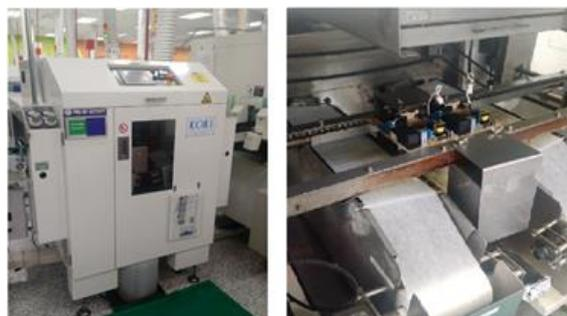
Figura 13: Máquina de aplicação de fluxo.
