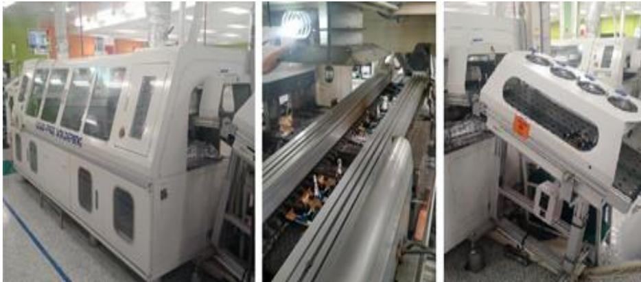
Figura 14: Máquina de solda do setor PBA.
