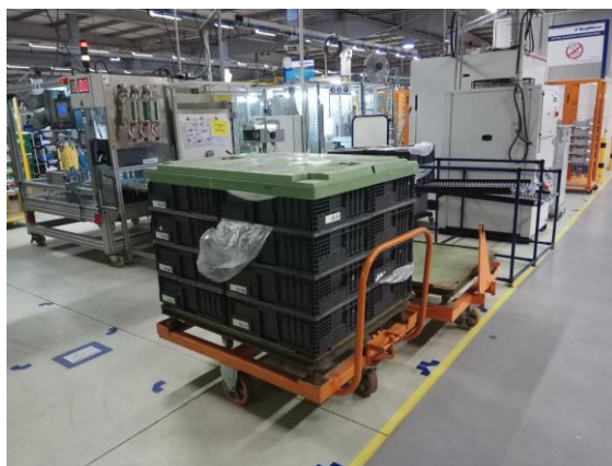
Figura 20 - Bordo de linha com estante e com 2 carros de produto terminado (Fase intermédia)
