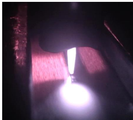
Figura 44 - Imagem capturada logo após a extinção do arco.
