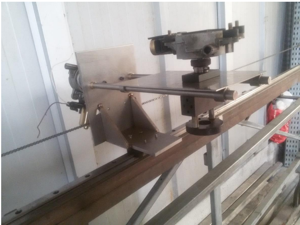
4. Colocação dos movimentos de altura e transversal na máquina.
