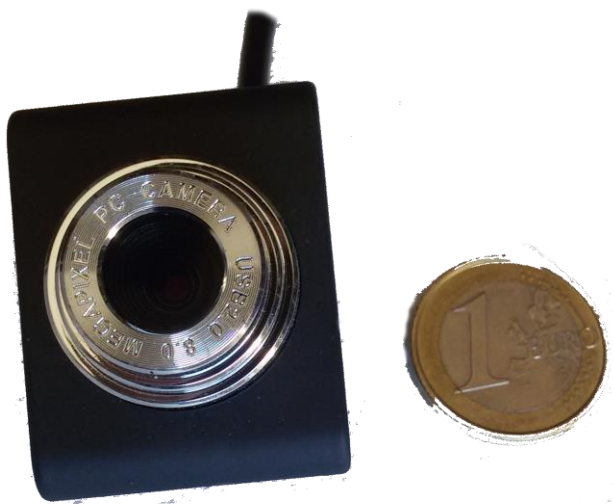
Figura 34 - Câmara utilizada para a obtenção de imagens.
