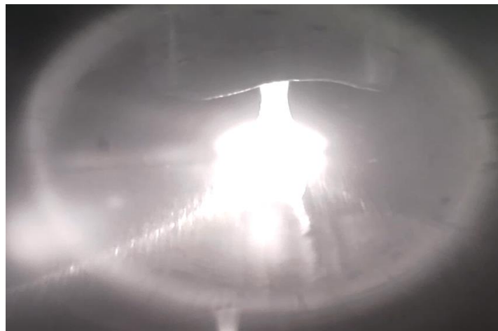
Figura 38 - Processo de soldadura gravado utilizando um filtro de 720 nm.
