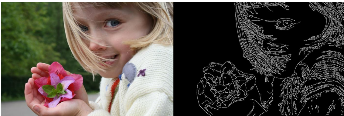
Figura 5 - Exemplo da aplicação da função canny , com a imagem original (à esquerda) e o resultado (à direita). 1
