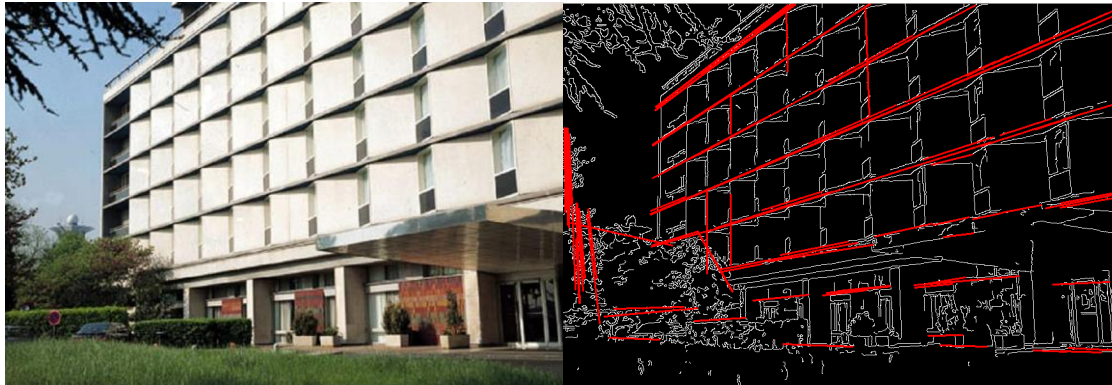
Figura 6 - Utilização da função HoughLines com os resultados salientados a vermelho. Imagem original (à esquerda); Imagem resultante (à direita). 2
