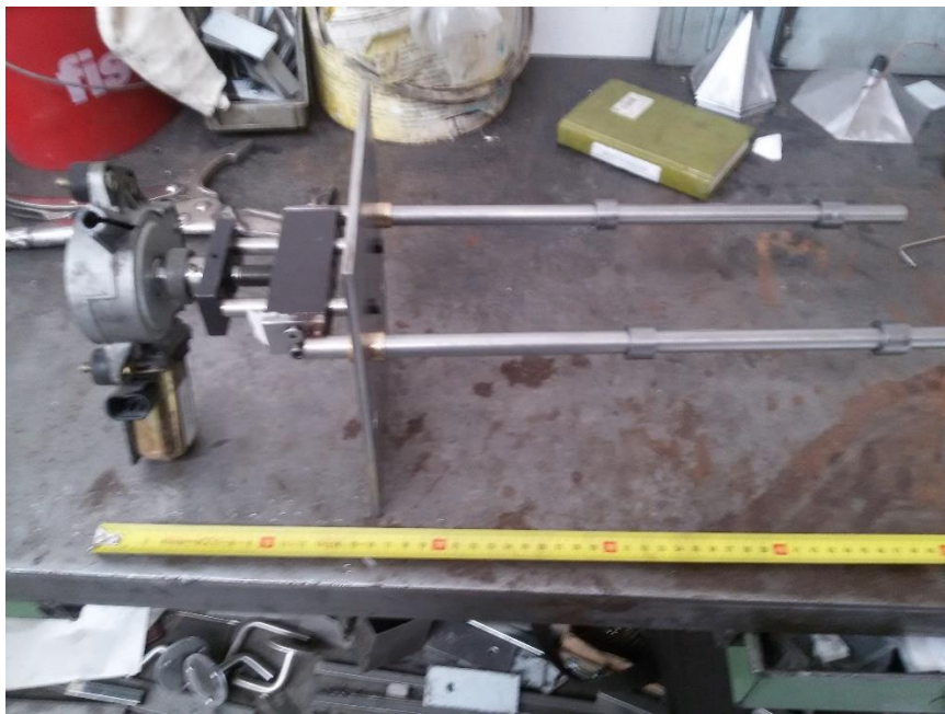
2. Construção do sistema de movimento transversal.
