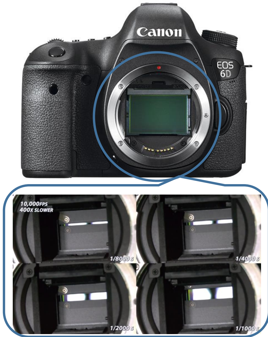
Figura 17 - Funcionamento de um obturador rolante mecânico com tempos de exposição progressivamente maiores. [23]
