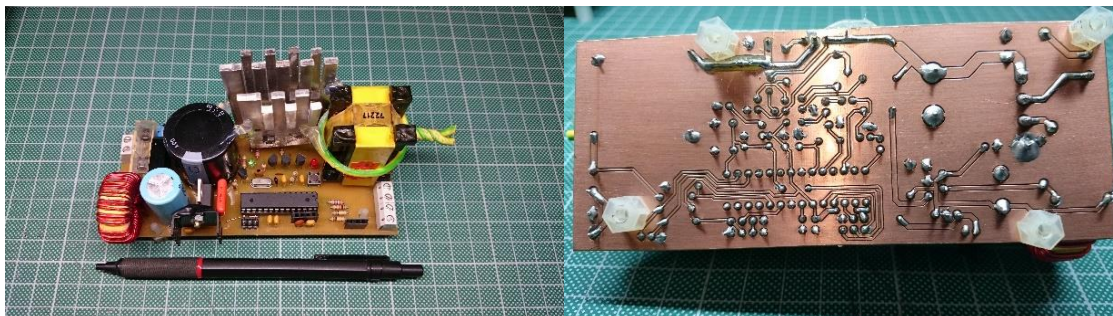
Figura 48 - Sistema de carregamento dos módulos de ultracondensadores implementado em PCB.
