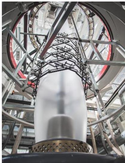
Figura 39 - Filme tubular da máquina "Blow2"
