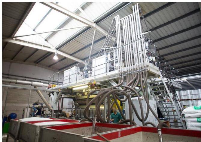
Figura 31 - Abastecimento de matéria-prima numa máquina *Cast*
