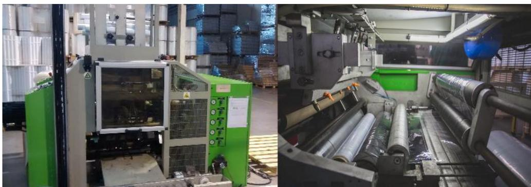
Figura 23 - Rebobinadora “Izyl” (esquerda) e processo de rebobinagem (direita)
