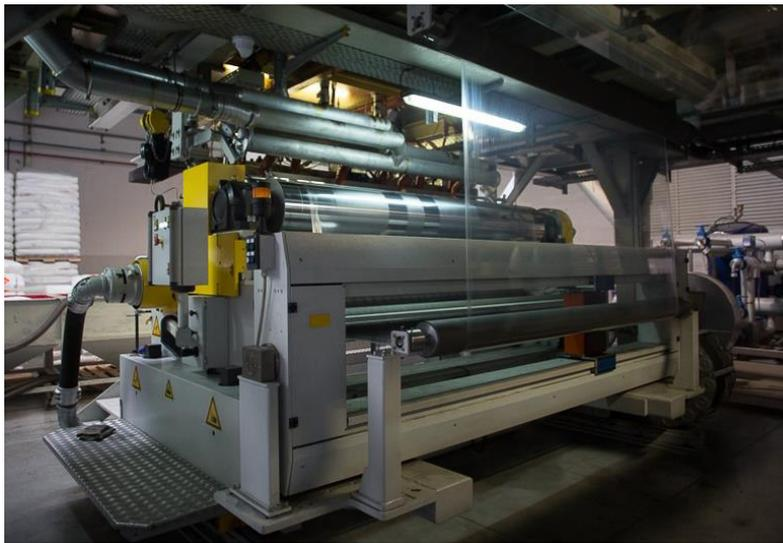
*Figura 32 - Filme extrudido na máquina Cast1*
