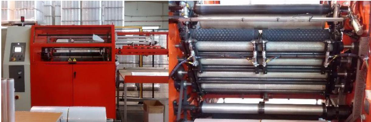
*Figura 24 - Pré-estiradora “Laranja2” (esquerda) e processo de pré-estiragem (direita)*
