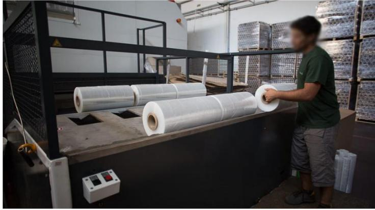
Figura 33 - Saída de bobines na máquina Cast2
