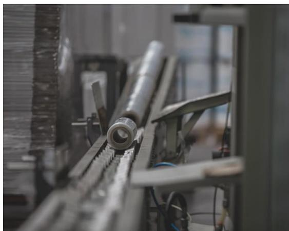
Figura 38 - Tapete rolante à saída das máquinas "Izzys" e "MakLaus"
