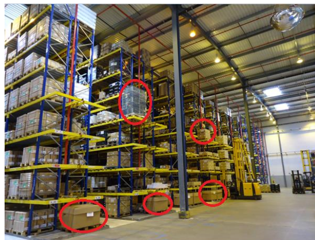
Figura 24 - Localização dos para-paletes e exemplos de paletes que aguardam alocação (sinalizadas a vermelho)
