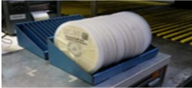
Figura 53 - Trays para colocação de bobines
