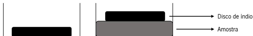
Figura 4.2 Representação esquemática da cápsula de amostra com o disco de Índio (esquerda) e com a amostra sobreposta com o disco de Índio (direita).
