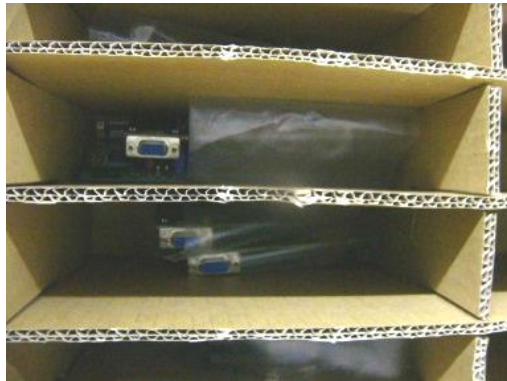
Figura 16 – Armazenamento incorreto de placas de circuito impresso (Fonte: documentação Interna)
