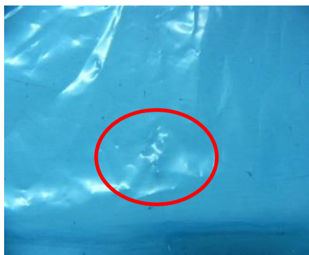
Figura 14 – Plástico perfurado por terminais de placas de circuito impresso (Fonte: documentação Interna)
