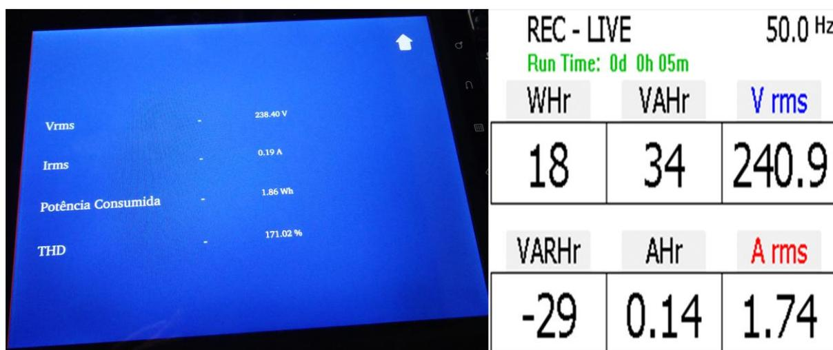
Figura 7-23 - Valores do ecrã TFT a partir do sistema desenvolvido e FLUKE 345
