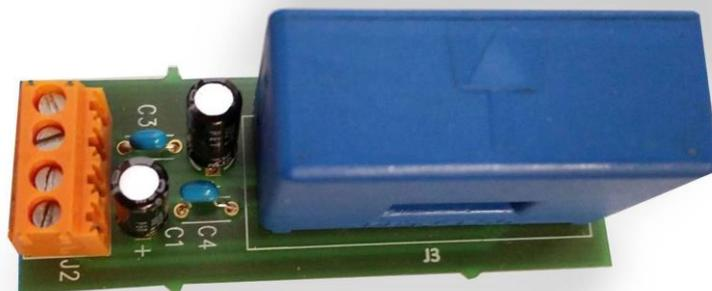
Figura 6-8 - Placa sensor de Corrente (GEPE)
