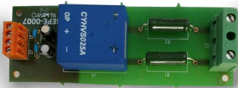
Figura 6-5 - Placa do sensor de Tensão (GEPE)
