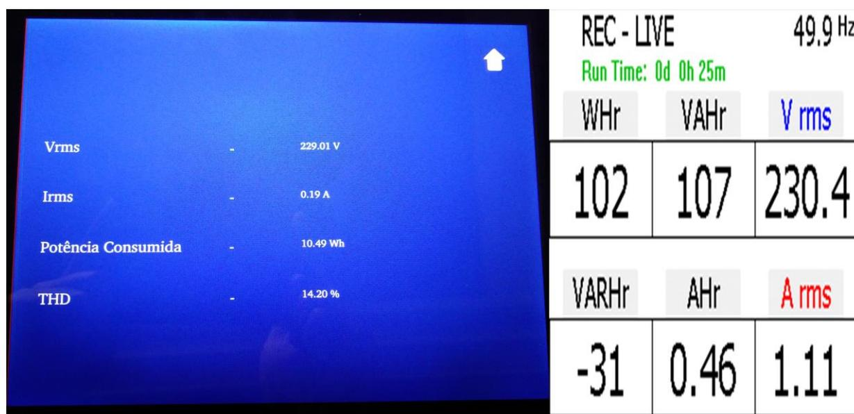
Figura 7-12 - Valores da ventoinha nível 1 a partir do sistema desenvolvido e FLUKE 345
