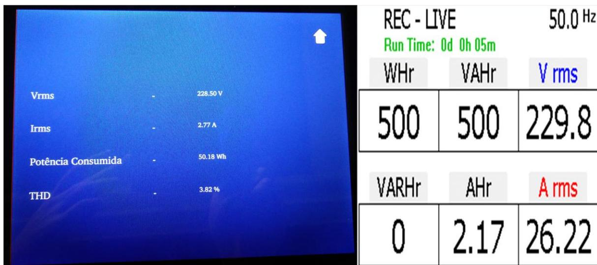
Figura 7-5 - Valores do aquecedor a partir do sistema desenvolvido e FLUKE 345
