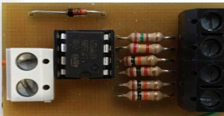
Figura 6-11 - Placa acondicionador de tensão
