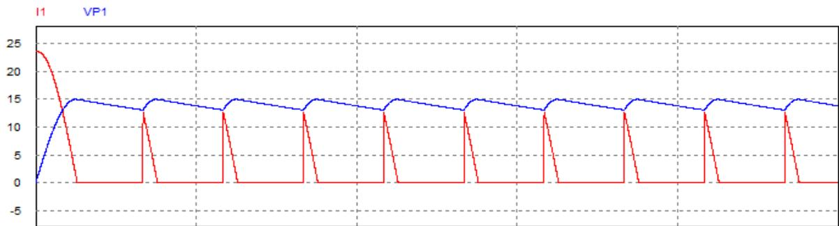
Figura 6-4 - tensão e Corrente saída da fonte (Transformador + Retificador + condensador) em Psim
