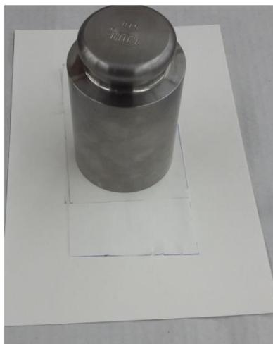
Figura 21: Ensaio “soil – release” segundo a norma AATCC Teste “Method” 130 – 2000 efetuado na amostra de PES.
