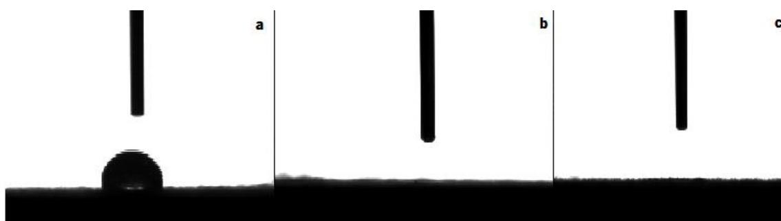
Figura 52: Ângulos de contacto ( $\theta$ ) de uma gota de água sobre a superfície de a) poliéster não tratado b) amostra de poliéster tratada com PEG (massa molecular média, 2000) e resina Adipret P-LF (60 g/L) c) amostra de poliéster tratada com PEG (massa molecular média, 2000) e resina Adipret P-LF (120 g/L).
