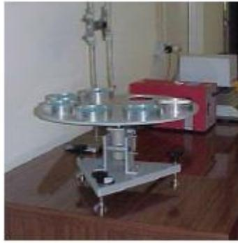
Figura 16: Aparelho “Control dish method” para avaliação da permeabilidade ao vapor de água
