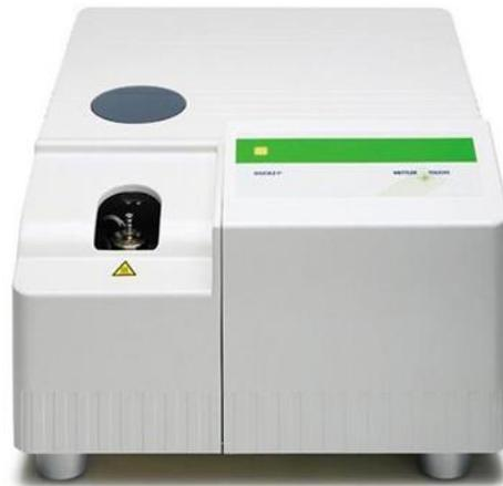
Figura 20: DSC utilizado neste trabalho: Modelo: DSC 822<sup>e</sup> da Mettler Toledo, com uma capacidade do forno de 200 W, intervalo de temperatura: -65°C a 500 °C, com “intercooler” e uma velocidade de aquecimento/arrefecimento: 1 a 20K/min.
