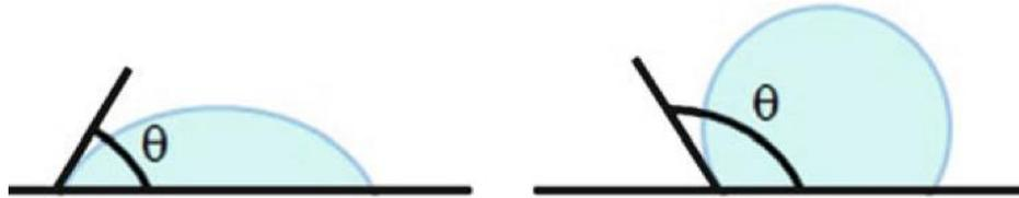
Figura 14: Ângulo de contacto de uma superfície hidrofílica e de uma superfície hidrofóbica
