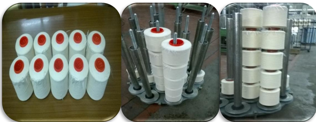
Figura 4 - Bobinas seleccionadas e identificadas colocadas no porta material.
