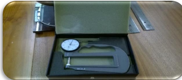
Medidor de espessura
