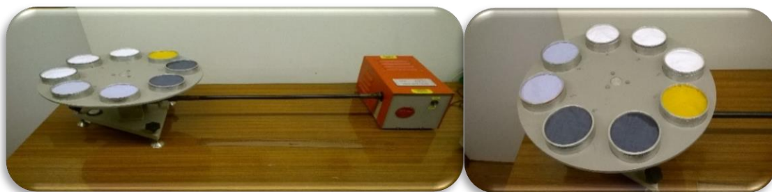
Permeabilímetro ao vapor de água “Control dish method”
