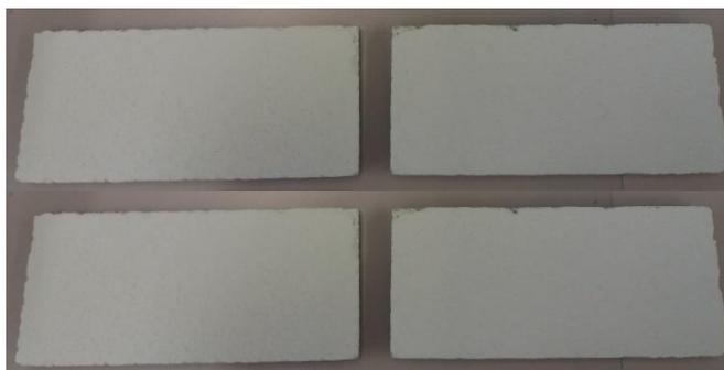
**Figura A5** – Fotografia dos provetes após ensaio de resistência aos álcalis dos ligantes hidráulicos (à esquerda, em cima e em baixo, os provetes que serviram de testemunho, das tintas P<sub>c</sub> e C, respetivamente, e à direita, em cima e em baixo os provetes sujeitos a ensaio, das tintas P<sub>c</sub> e C, respetivamente).
