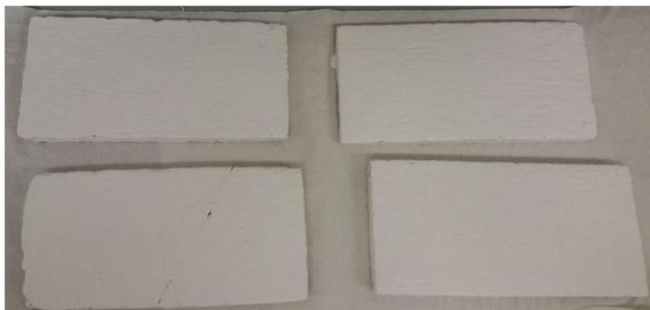
**Figura A1** – Fotografia dos provetes após ensaio de resistência aos álcalis dos ligantes hidráulicos (à esquerda, em cima e em baixo, os provetes que serviram de testemunho, das tintas  $P_A$  e A, respetivamente, e à direita, em cima e em baixo os provetes sujeitos a ensaio, das tintas  $P_A$  e A, respetivamente).
