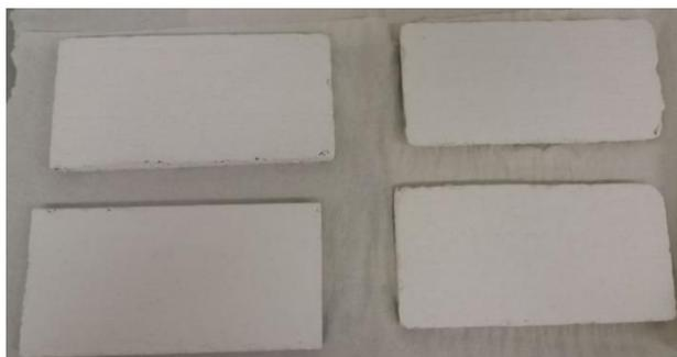
**Figura A3** – Fotografia dos provetes após ensaio de resistência aos álcalis dos ligantes hidráulicos (à esquerda, em cima e em baixo, os provetes que serviram de testemunho, das tintas P<sub>B</sub> e B, respetivamente, e à direita, em cima e em baixo os provetes sujeitos a ensaio, das tintas P<sub>B</sub> e B, respetivamente).
