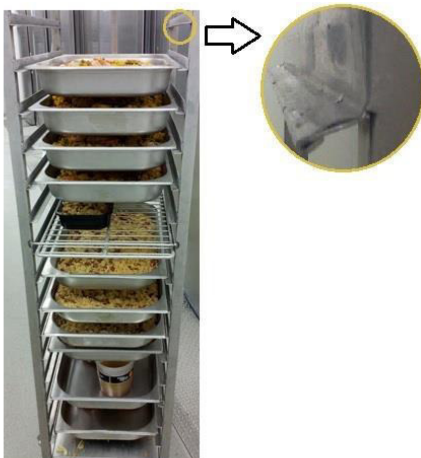
Figura 16. Estado de conservação das calhas dos diferentes níveis do carro.
