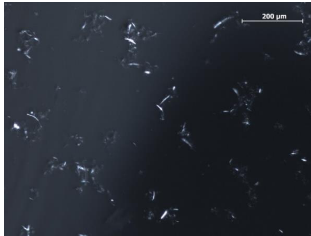
Figura 22 – Fotografia de uma amostra da solução com X_{PVA} = 14\% e Y_{NFC} = 3\% . A imagem foi adquirida com uma ampliação de 100\times , sendo a escala correspondente igual a 200\ \mu\text{m} . A solução antes da análise foi sujeita a 10 min no banho de ultrassons. No microscópio ótico com luz polarizada, as estruturas birrefringentes, como a celulose, aparecem como estruturas brilhantes sob um fundo escuro. [70]
