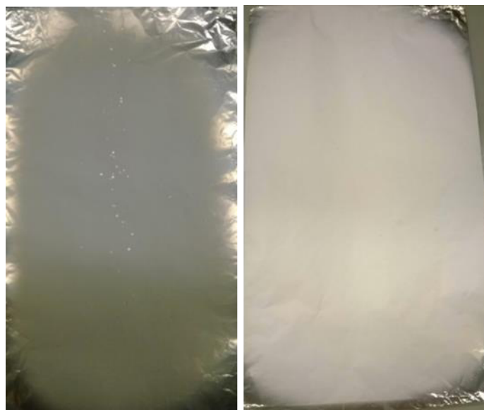
Figura 20 – Fotografias das membranas obtidas por electrospinning a partir de soluções com diferentes concentrações de PVA e de NFC. Na imagem da esquerda, a solução usada continha um x_{\text{PVA}} = 12\% e um y_{\text{NFC}} = 10\% . Na imagem da direita, a solução utilizada para o ensaio apresentava um x_{\text{PVA}} = 14\% e um y_{\text{NFC}} = 3\% . A alteração das concentrações permitiu alcançar parâmetros de electrospinning adequados à produção de fibras, cessando o gotejamento da solução durante o ensaio.
