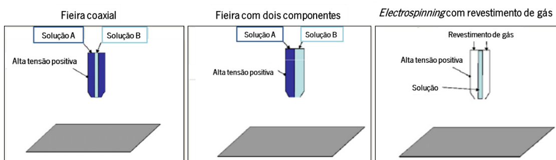
Figura 7 – Diagramas esquemáticos de configurações de electrospinning usando vários tipos de fornecimento de solução com modificações na feira (Imagens adaptadas da referência [15]).
