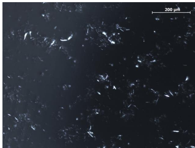
Figura 23 – Fotografia de uma amostra da solução de (PVA/MA/NFC), na proporção de 20 mol de PVA para 1 mol de MA, com X_{PVA} = 14\% e Y_{NFC} = 3\% . A imagem foi capturada com uma ampliação de 100\times , com uma escala correspondente a 200\ \mu\text{m} . A solução antes da análise foi sujeita a 10 min no banho de ultrassons. No microscópio ótico com luz polarizada, as estruturas birrefringentes, como a celulose, aparecem como estruturas brilhantes sob um fundo escuro. [70]
