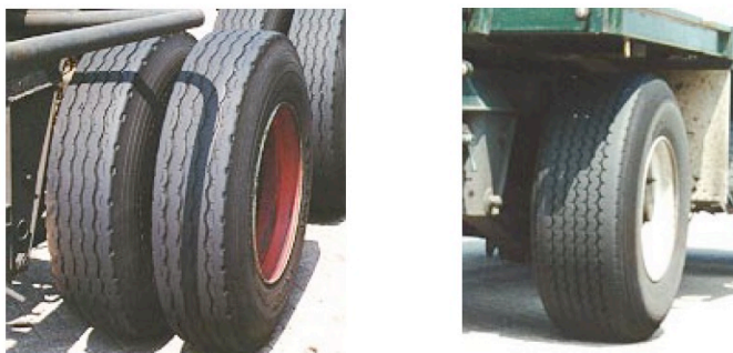
Figura 2 – Exemplo de roda dupla e roda simples (Addis, 2000)
