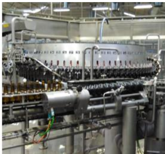
Figura 18- Soprador de garrafas
