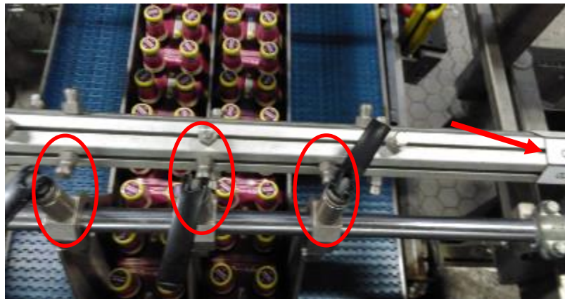
Figura 54 - Guias verticais posicionadas pelos pinos dos rolos identificados
