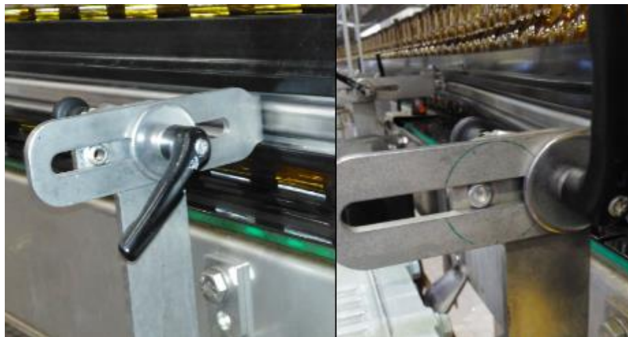
Figura 46 - Marcação Guias Enchedora
