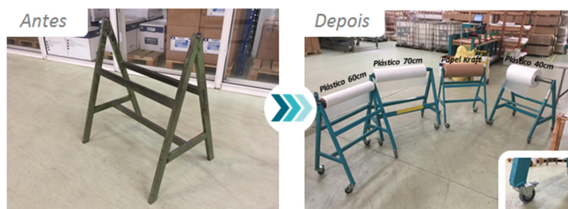
Figura 111- Antes e depois da implementação dos 4 novos cavaletes
