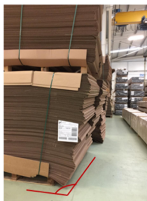
Figura 40- Falta de segurança causada pelo empilhamento de paletes
