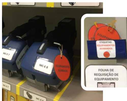
Figura 98- Propostas para a identificação de ferramentas de embalagem avariadas
