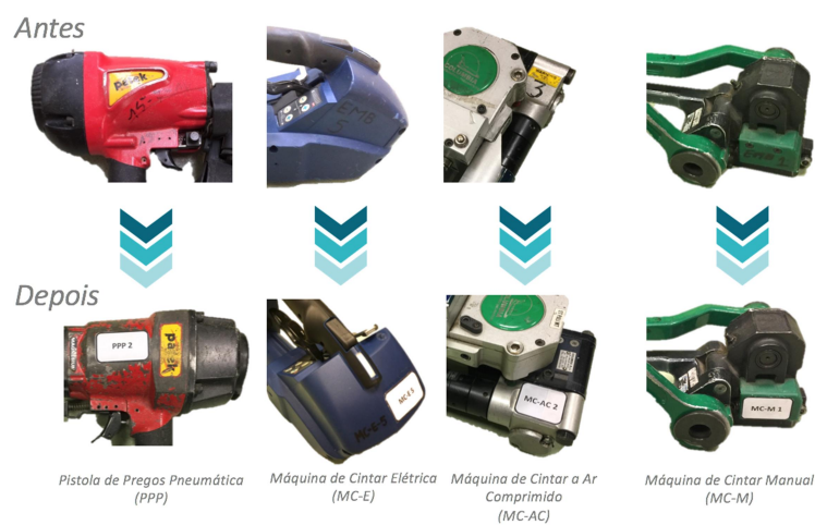
Figura 114- Antes e depois da recodificação das ferramentas de embalagem
