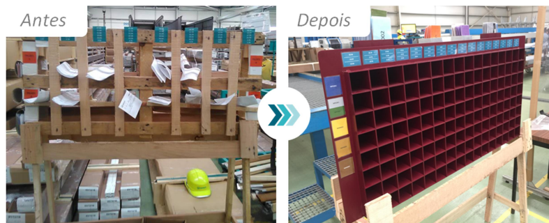
Figura 87- Criação de novas caixas de nivelamento
