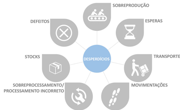
Figura 6- Os sete tipos de desperdícios (adaptado de Melton, 2005)
