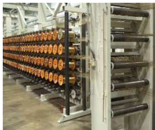
(c) Vista da pré-fieira de uma estante de pinos (reproduzido de Tire Technology International, 2017).
