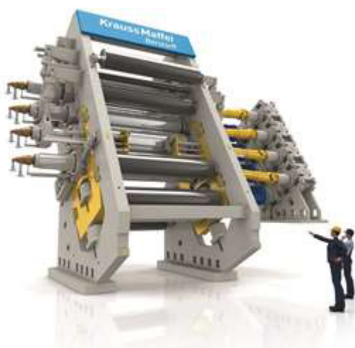
(a) Desenho tridimensional dos rolos e estrutura de suporte (reproduzido de KraussMaffei Berstorff, 2017)
