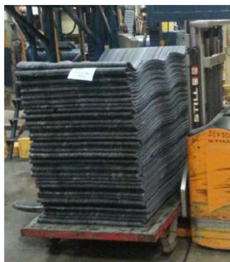
(b) Mesa com lençóis de composto de borracha (reproduzido de Carvalho, 2015).
