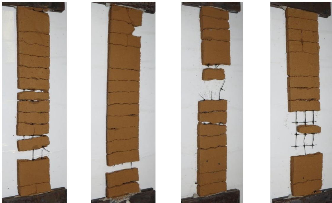
Figura 5.15: Modos de rotura dos provetes da malha G8 embebida em argamassa.
