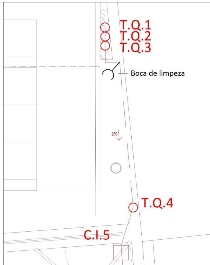
Figura 5.10: Pormenor da rede de drenagem de águas residuais do rés-do-chão do edifício em estudo para a presente dissertação
