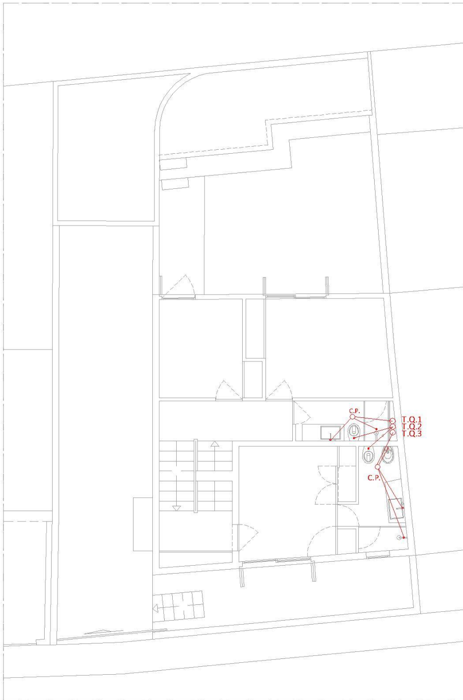
Planta do 1º piso com a respetiva rede de drenagem de águas residuais
