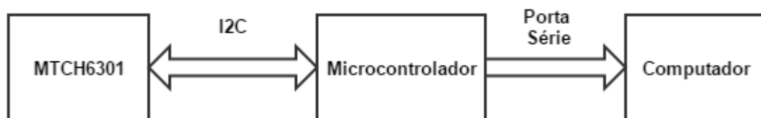
Figura 27- Diagrama representativo das comunicações do microcontrolador com o circuito de leitura e com o computador
