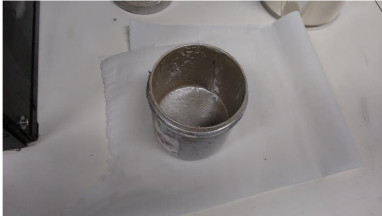
Figura 30 - Tinta de prata utilizada na impressão
