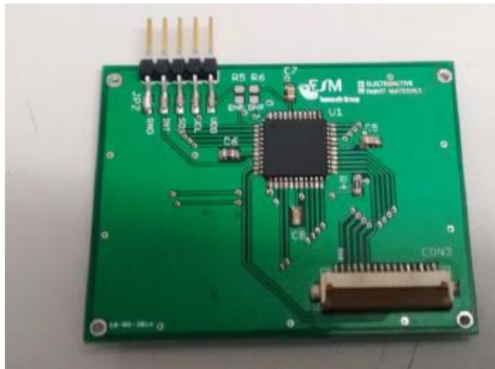
Figura 40 - PCB desenvolvida do circuito de leitura
