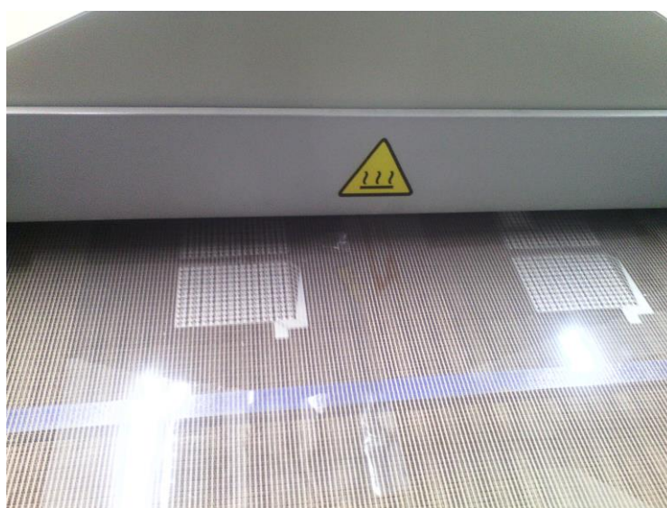
Figura 37 – Processo de cura das matrizes
