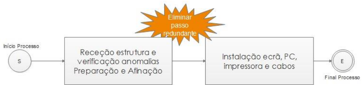
Figura 38 – Kaizen Burst no Processo de montagem de quiosques
