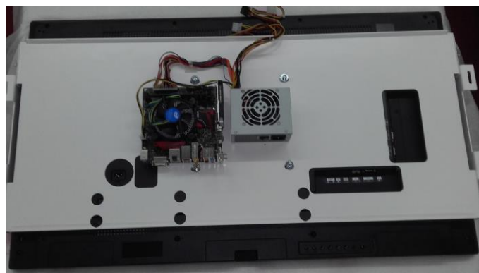
Figura 22- Chapa montada com ecrã, computador e fonte de energia
