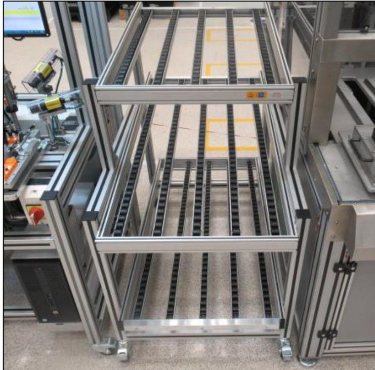
**Figura 41- Exemplo de uma rampa de abastecimento**
