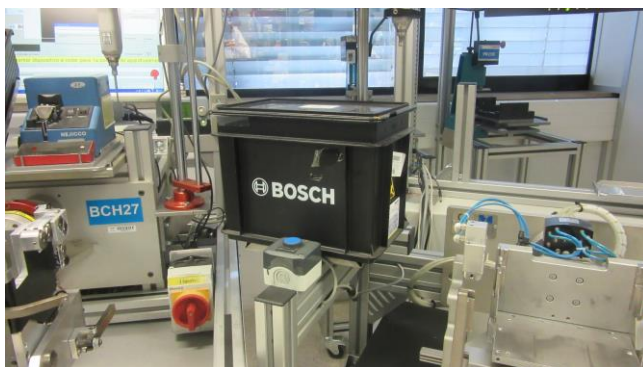
Figura 24 - Caixas fora de rampa de abastecimento
