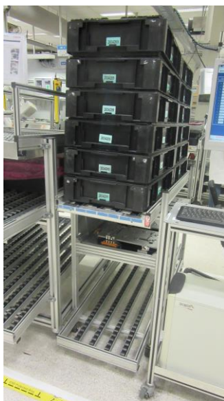
Figura 25 - Rampa sem Capacidade para o Material a ser Consumido pela Linha de Produção
