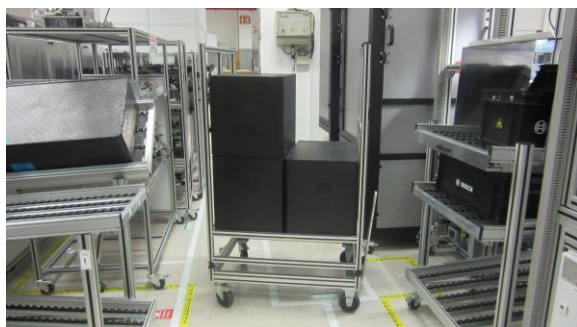
Figura 26 - Canal de passagem bloqueado
