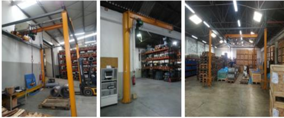
Figura 21- Meios para movimentação de carga (ponte de segregação de massas, braço de coluna para separação de carcaças e ponte para abertura de caixas de paletização de material)
