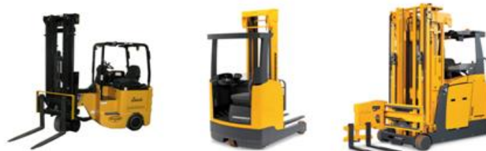
Figura 33- Equipamentos de movimentação de cargas que correspondem as necessidades (à esquerda: empilhador de cabeça rotativa; ao centro: empilhador retrátil; à direita: trilateral)
