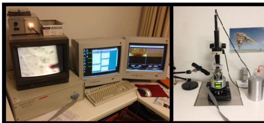
Figura 37 - Composição da aparelhagem necessária para o ensaio AFM: à esquerda, conjunto computacional para leituras controlado pelo sistema Nanooscope III da Digital Instruments; à direita, apresenta-se o Microscópio MultiMode
