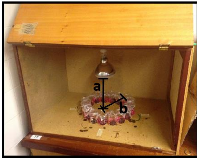
Figura 42 - Camara de simulação, distância ( a= 22 cm) é da lâmpada á superfície da RB e a de ( b= 12 cm) é do centro da gobelé ao centro da lâmpada.
