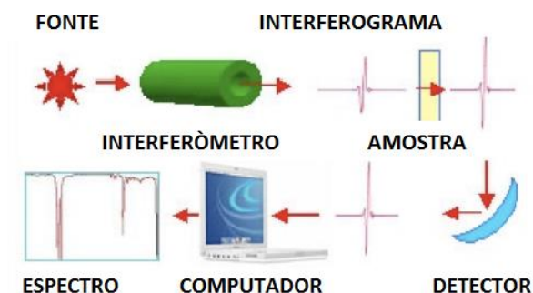
Figura 38 - Técnica do processo de uma análise de uma amostra (Leite 2008)
