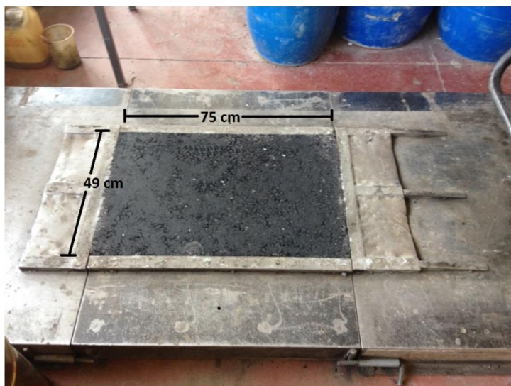
Figura 27 - Laje fabricada em molde metálico
