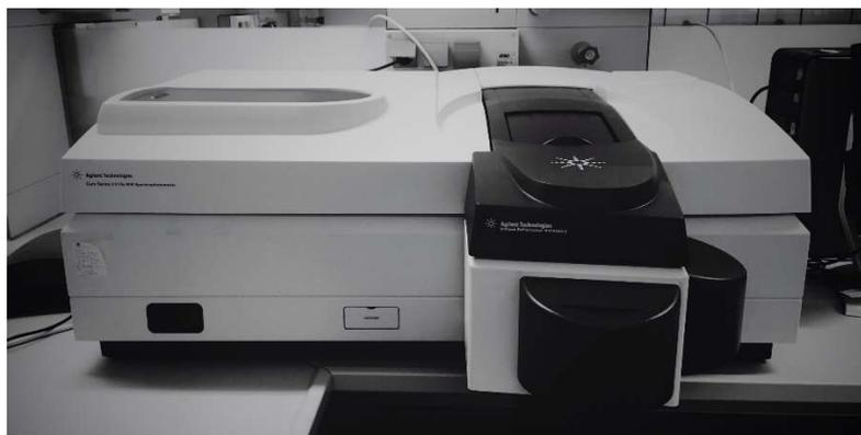
Figura 2.6 Espectrofotómetro UV-Vis-NIR equipado com uma esfera integradora.
