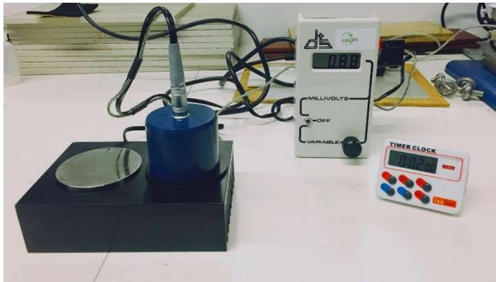
Figura 2.9 *Emissoímetro* modelo AE1.
