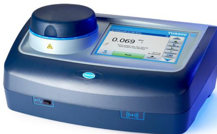
Figura 12 – Turbídmetro TU5200 utilizado no laboratório da ARHN, que mede a turvação a 90 ° da fonte de luz. Fonte: Hach ® 49 .
