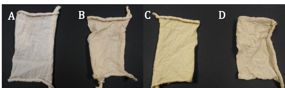
Figura 25: Efeito do envelhecimento da infusão na cor dos provetes de lã colorida com infusão de boldo envelhecida (B) e lã colorida com infusão de noqueira envelhecida (D). Provetes controlo de lã colorida com boldo (A) e noqueira (C).
