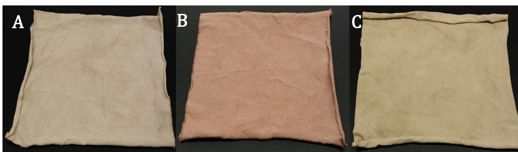
Figura 30: Efeito da acidificação do banho de coloração de P. tinctorius nos provetes de algodão (A), algodão cationizado (B) e algodão pré tratado com alúmen (C).
