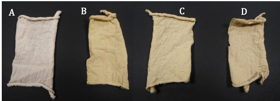
Figura 22: Efeito do tratamento com lacase nos provetes de lã colorida com infusão de boldo (B) e noqueira (D). Provetes controlo lã colorida com infusão de boldo (A) e noqueira (D).
