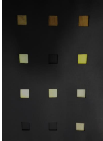
Figura 9: Esquema do método utilizado para expor os provetes coloridos à luz solar recorrendo a uma cartolina com recortes de 1 cm 2 .
