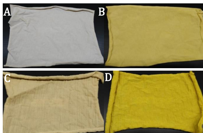
Figura 14: Efeito do pré-tratamento com alumínio nos provetes de lã e algodão. Algodão (A), algodão pré tratado com alumínio (B), lã (C), lã pré tratada com alumínio (D) coloridos com infusão de noqueira.
