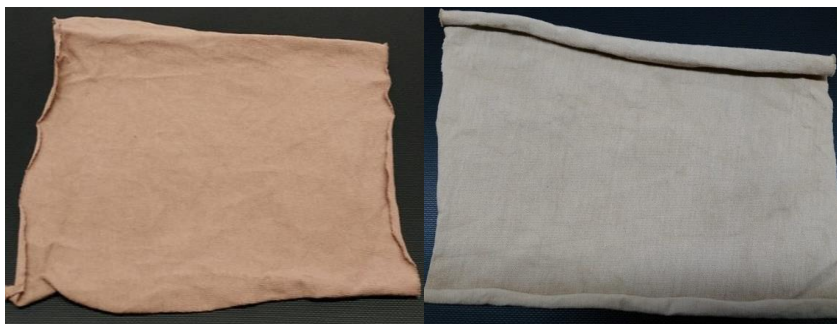
Figura 31: Efeito da alcalinização do banho de coloração de P. tinctorius nos provetes de algodão cationizado.
