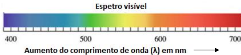
Figura 6: Espectro de luz visível, em que o comprimento de onda (nm) aumenta da esquerda para a direita (Adaptado de Gurses et al., 2016).
