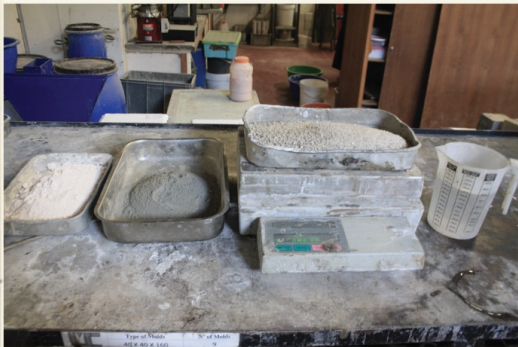
Preparação da Argamassa
