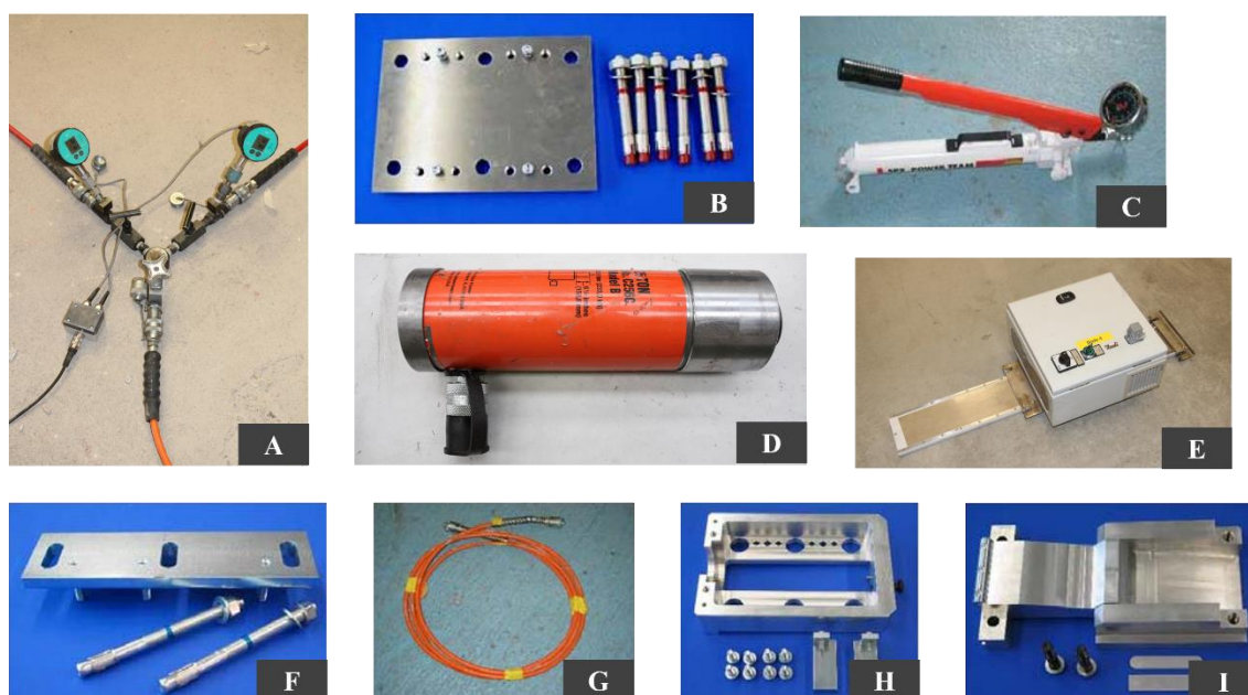
Figura 2 – Equipamentos utilizado nos sistemas de ancoragem: (a) manómetro e válvulas; (b) chapas de ancoragem; (c) macaco hidráulico; (d) cilindro hidráulico; (e) Dispositivo de aquecimento; (f) guias metálicas; (g) mangueiras hidráulicas; (h) quadro metálico; e (i) unidade de aperto.
