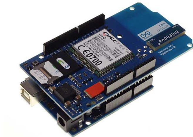
Figura 5-2 - Ligação do módulo GSM com o Arduino [15]
