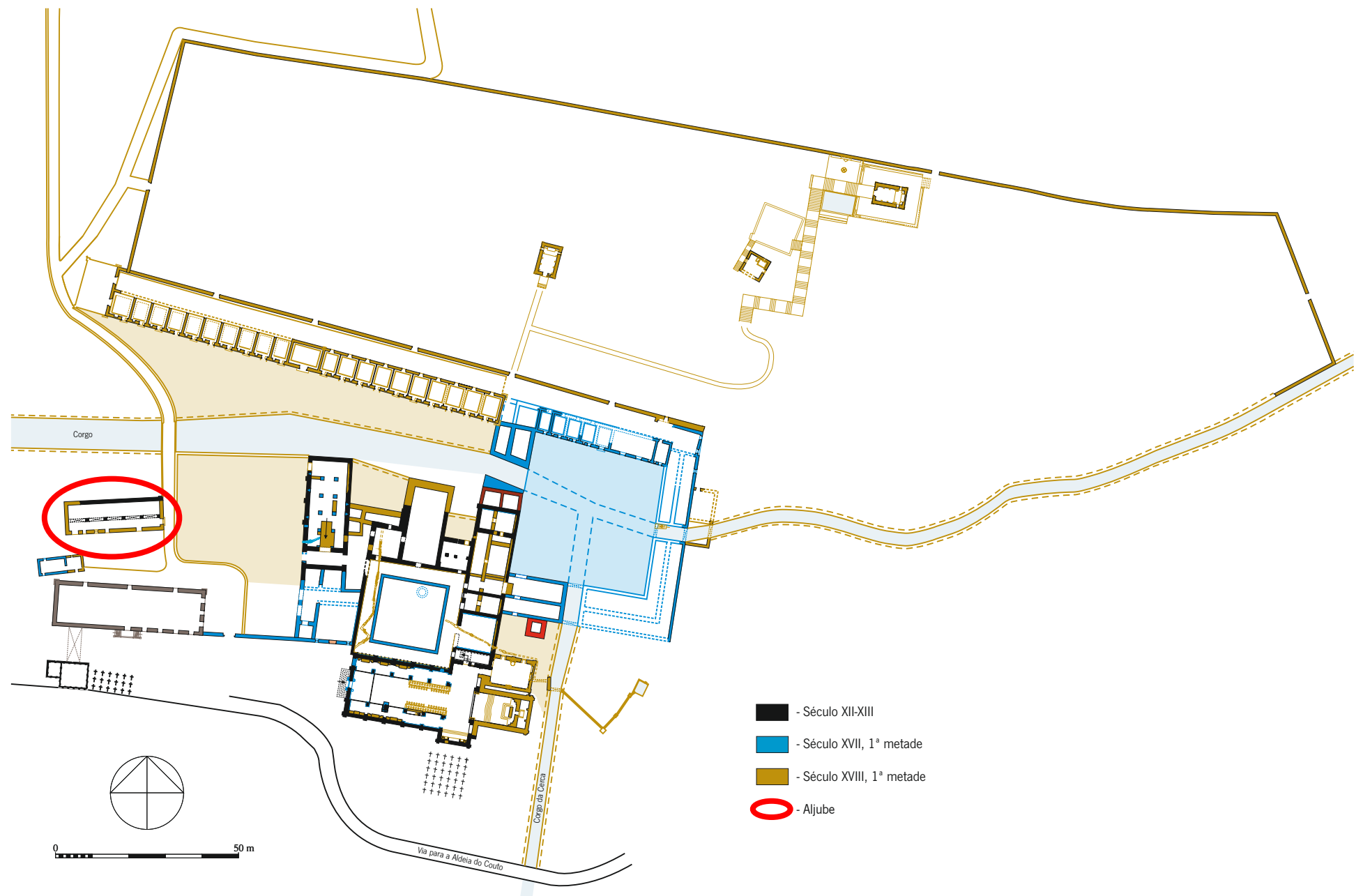
1.2 Adaptação da planta do mosteiro de São João de Tarouca com as três principais fases construtivas assinaladas publicada em 2015 (Sebastian, 2015, p.27, figura 36)
