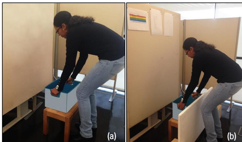
Figura 3.12: Aparato experimental da posição de alcance da carga (a) sem e (b) com barreira.
