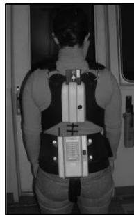
Figura 2.9: Monitor de movimento lombar usado para determinar dados cinemáticos (reproduzido de Matthews et al. , 2007).
