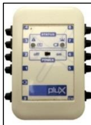
Figura 3.9: Aparelho portátil bioPLUX ® usado na recolha de dados de EMG.
