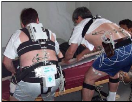
Figura 2.10: Participantes com o MML e o eletromiógrafo durante a transferência de um doente, simulada em Lavender et al. (2007b).
