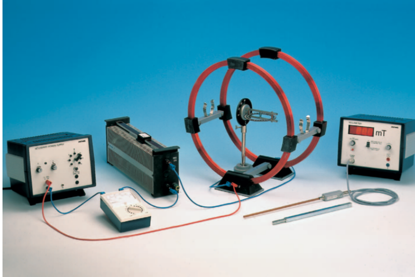
Figura 10: Teste experimental para determinar o campo magnético da Terra [16].
