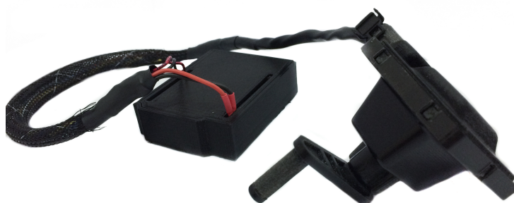
Figura 57: Sensor angular diferencial e sistema de leitura.
