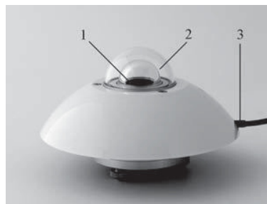
Figura 2.7 - Piranómetro . (1) – Absorvedor de corpo negro. (2) Vidro protetor. (Chen, C 2011)
