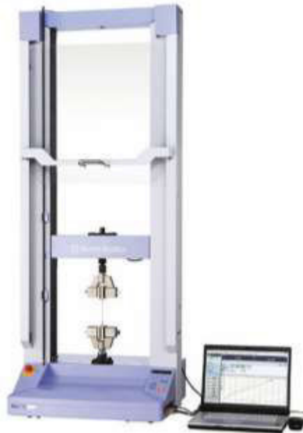
Figura 26 – Equipamento AGS-X Shimadzu 500 N usado para determinação da resistência mecânica das fibras à tração.
