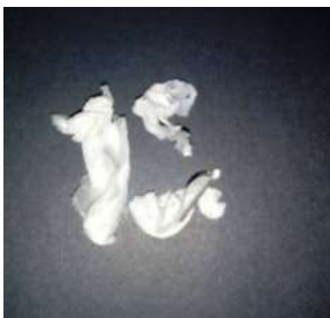
Figura 34 – Nanofibras de zeína produzidas por electrospinning a partir de soluções de zeína a 30 % (m/m) num solvente misto de etanol:água (8:2).
