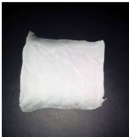
Figura 37 – Nanofibras de PCL com ACV e ómega-3, preparadas por electrospinning .
