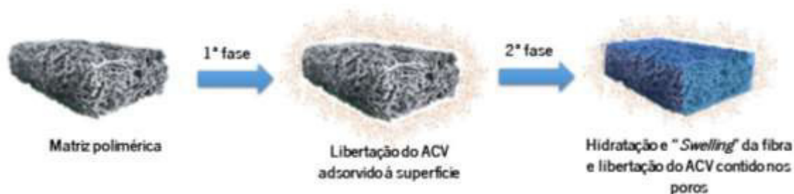
Figura 46 – Representação esquemática da libertação do fármaco ACV da matriz polimérica das nanofibras que justifica uma cinética bifásica ajustada pelo modelo de Gallagher-Corrigan.
