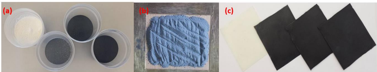
Figura 17: (a) MCC de PA6/Grafite exfoliada; (b) MCC antes da moldação por compressão; (c) Compósitos obtidos por moldação por compressão.
