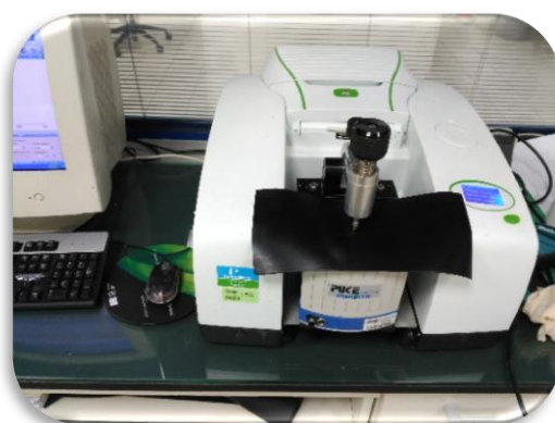
Figura 36- Aparelho de FTIR-ATR com filme da mini-extrusora da empresa
