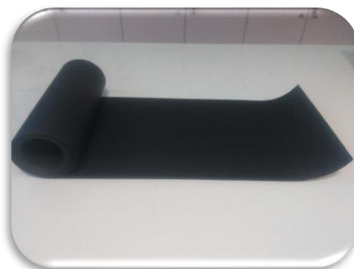
Figura 40- Filme extrudido na mini-extrusora do fornecedor
