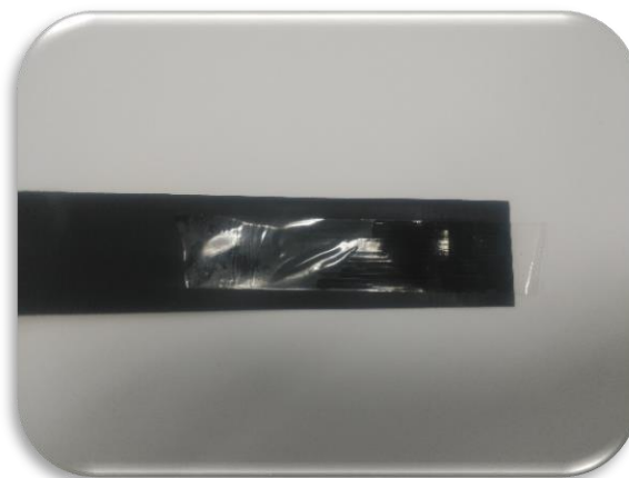
Figura 38- Realização do ensaio de cross-cut num filme lacado
