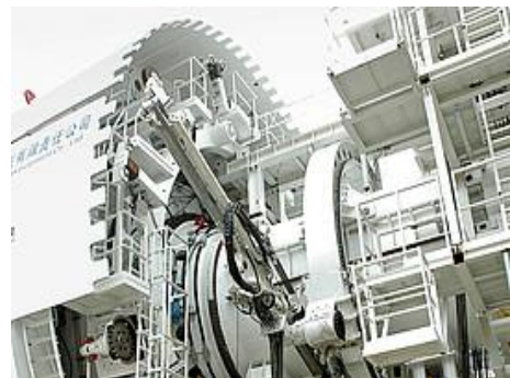
Fig.256-Zona montagem de pregagens [319]
