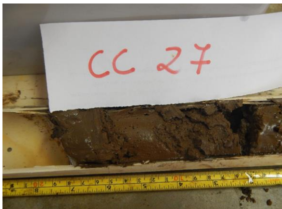
Figura 2 - Testemunho vertical de sedimentos obtido no ponto 27 da UHE Caçu (Topo margem esquerda- base margem direita da foto).
