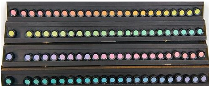
Figura 1.30: Teste de Farnsworth-Munsell de 100 tonalidades – as cápsulas estão divididas por quatro caixas. (Retirado de [37])
