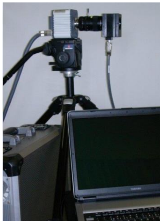
Figura 3.5: Sistema de imagiologia híperespectral, disponível no Colour Science Lab (CSL) da Universidade do Minho (Braga, Portugal).
