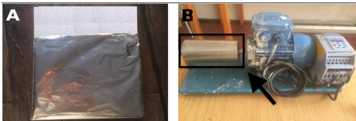
Figura 3.7 – Coletores utilizados durante o processamento de fibras por *eletrospinning*: A - estático e B - rotativo.
