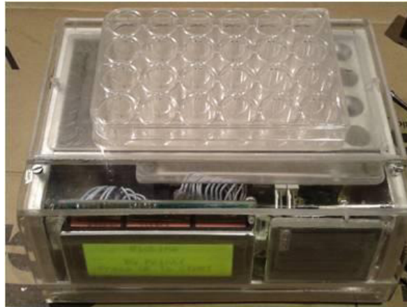
Figura 2.9: Biorreator com estímulo magnético para cultivos celulares dinâmicos.
