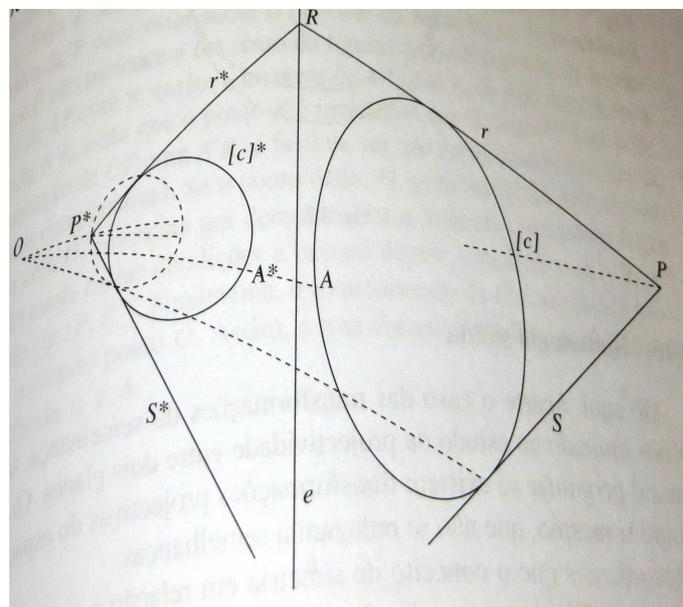
Figura 3: Exemplo da determinação das tangentes à elipse.
