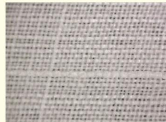
Lado avesso da peça. Teia: 56 fios/cm Trama: 52 fios/cm
