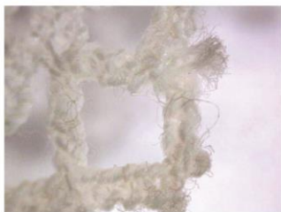
Imagem 6: O filamento contínuo é nítido nesta laçada na parte da frente da roupa. Foi observado o brilho natural da seda. Ampliação: 42 x.
