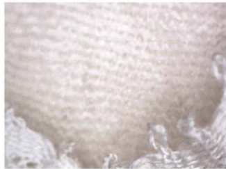
Imagem 6: Identificação da fibra de algodão na parte de baixo, nesta imagem do furo da camisola. Ampliação 42 x.
