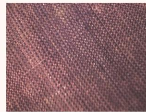
Lado avesso da capa com capuz, parte interior ( forro). Teia: 54 fios/cm Trama: 40 fios/cm
