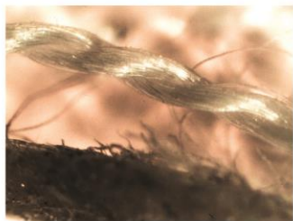
Imagem 7: Detalhe da parte das costas da camisa. A identificação das fibras é possível mediante a observação deste feixe de fios que mostram as formas lisas da fibra do linho. Apresenta também um formato em nódulos e o brilho natural característico desta fibra. Ampliação: 40x.
