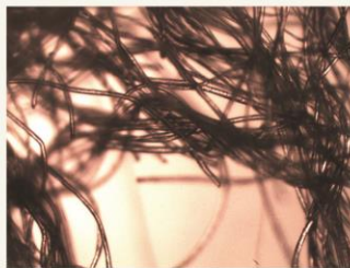
Imagem 8: Parte da frente do colete lado direito, foi observada a vista longitudinal da fibra da lã. Ampliação: 40x.
