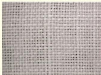
Lado direito da camisa de Dom João VI, parte da frente. Teia: 56 fios/cm Trama: 52 fios/cm
