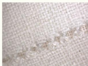
Imagem 8: Detalhe da manga da camisinha, onde é percebida a fibra do linho neste alinhavo da construção da peça. Ampliação: 42 x.
