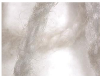
Imagem 6: As costas da peça Matinée, que evidencia a torção do fio de algodão. Ampliação 42 X.
