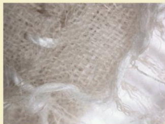
Imagem 9: Lado avesso da camisola, onde a identificação da fibra de algodão é possível mediante a observação destas fibrilas “despenteadas”, ou seja, observa-se a incidência de fibrilas sobressaindo da estrutura do fio, característica típica de um fio de algodão de fibras curtas. Ampliação 42 X.
