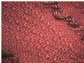
Imagem 3: Detalhe na frente da jaqueta de mulher na parte da fibra de lã, evidenciando a construção do tecido lavrado. Ampliação 7x.
