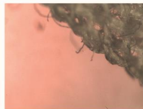
Imagem 8: Pormenor da fibra de linho, correspondente ao forro do ombro nas costas. A identificação das fibras é possível mediante a observação desta imagem que mostra as características longitudinais da fibra de linho. Ampliação: 40 x.
