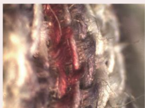
Imagem 8: Lado direito do corpete, a identificação do filamento de seda é possível mediante a observação do formato liso e transparente da seda, evidenciado nesta imagem. Ampliação: 40 x.
