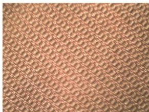
Imagem 5: Pormenor da fita de cetim aplicada na camisa de senhora na parte da frente. Ampliação 7x.
