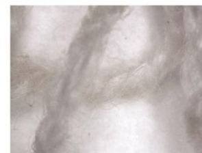
Imagem 5: A identificação da fibra de algodão é possível mediante a observação deste feixe, no qual se nota as fibrilas sobressalentes, característica de fios de algodão, de fibra curtas. Ampliações 42 X.
