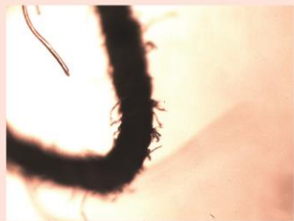
Imagem 7: Parte da frente do colete lado esquerdo. A identificação é possível mediante a observação de fio característico da fibra de lã. Ampliação: 45x.
