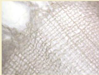
Imagem 7: Detalhe da trama rasgada da camisola, que evidencia a fibra de algodão, onde é visível a uniformidade característica desta fibra. Ampliação: 42 x.
