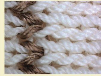
Imagem 11: Detalhe do avesso da meia, evidenciando fios grossos na cor marrom. Aproximação 42 X.
